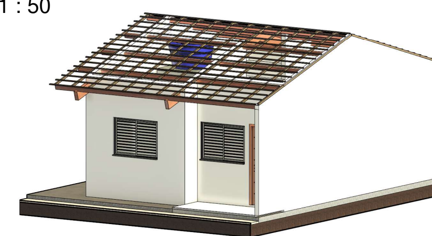
13 Detalhe Telhado
